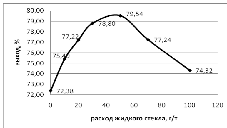
Рис. 4.9. Выхода кварца в пенный продукт при флотации амином и с добавлением жидкого стекла ( \text{pH} = 9,5 , C_{\text{амин}} = 8,33 мг/л)
